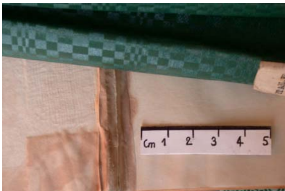
9 Un exemple d'équipement inapproprié: une reliure bon marché en plastique ayant un effet abrasif sur le papier .
