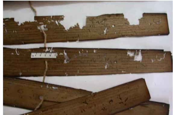
8 Traces de feu et dégradations dues à un insecte de type "vrillette"
